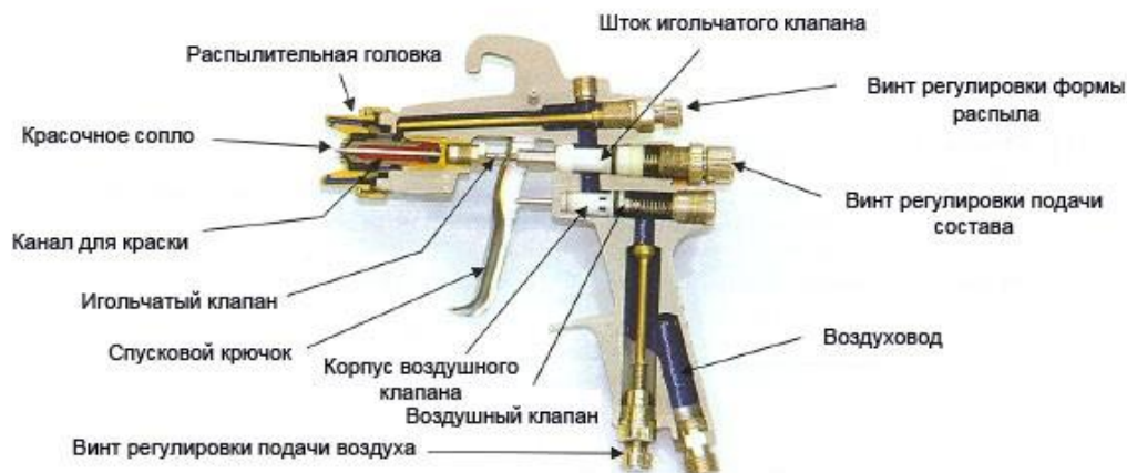
Устройство воздушного распылителя
